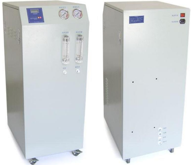
沛亿 Ultimate 系列超纯水机除了以上针对性设计外，还有：**集成预处理、反渗透、后处理于一个带万向机轮的机箱，安装维护方便，结构配管科学；美国进口单片机 CPU 全自动控制，故障自检声光报警系统，LED 液晶屏在线显示产水水质，符合人机工程学设计的人机操作界面，全防水安全薄膜取水按键等技术特点。**
